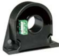
应用霍尔效应开环原理的电流传感器，能在电隔离条件下测量直流、交流、脉冲以及各种不规则波形的电流。
