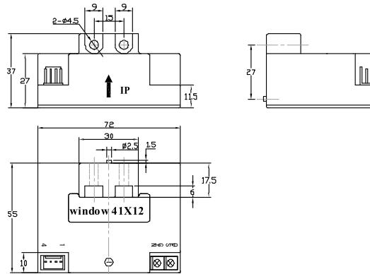
引脚输出： 1:+15V 2:-15V 3:Vout 4:0V(电源地) OFS,零点调节GIN,幅度调节引线输出： 红:+15V 蓝:-15V 黄:Vout 黑:0V(电源地)
