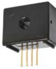
应用霍尔效应开环原理的电流传感器，能在电隔离条件下测量直流、交流、脉冲以及各种不规则波形的电流。
